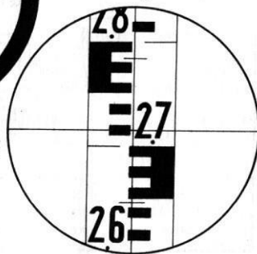
Поле зрения зрительной трубы нивелира Н-10КЛ
